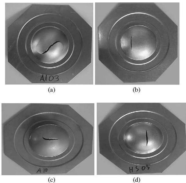
Fig. 11. Bulged samples: (a) AKDQ steel; (b) HS steel; (c) aluminum AA 6111; (d) ferritic stainless steel.
