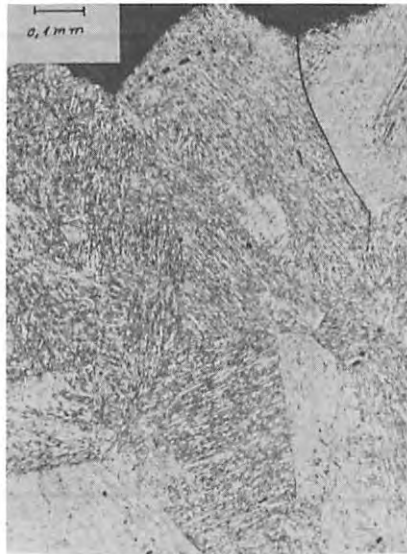
Bild 4 3%ige \text{HNO}_3 -Ätzung Rißverlauf einer gekerbten Zeitstandprobe des Stahles 22 NiMoCr 36
