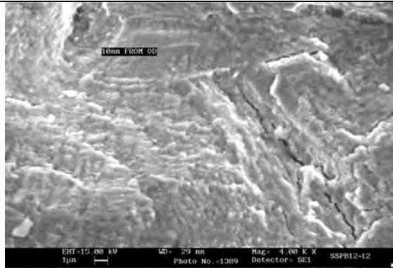
Fig: 7e: Fatigue fracture surface (SSPB12-12)
