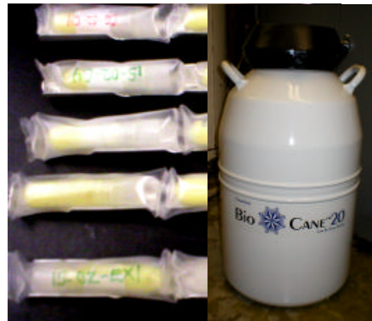
Figura 11. Frascos criogénicos de marca Nunc® (Izq.) y una heladera criogénica (Der.) para almacenamiento en nitrógeno líquido.
