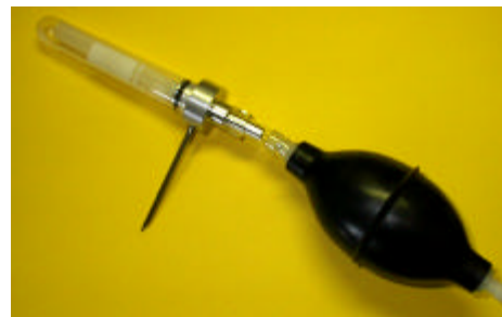
Figura 9. Polinizador de ciclón armado en CAMCORE, basado en los diseños de la Cooperativa NCSU-TIP y MeadWestvaco.
