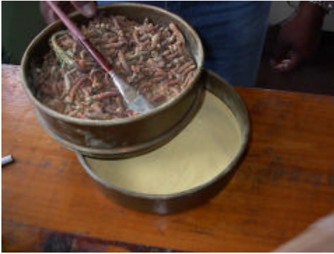
Figura 7. Un método simple para la limpieza de polen. Después de la extracción primaria, se pasa el polen por tejidos sucesivamente más finos para sacar restos y larva de insectos. (La foto muestra polen Pinus tecunumanii en Guatemala.)
