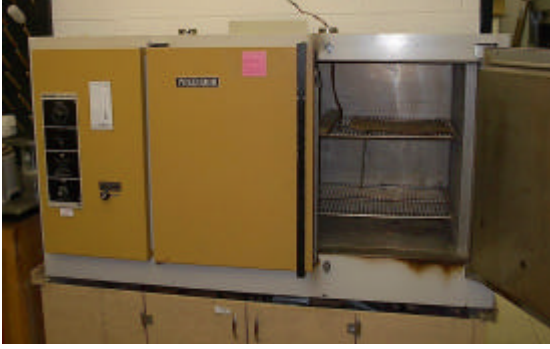
Figura 8. Un horno secador de aire forzado de marca Precision® aceptable para el secado de polen en 29-30° C.
