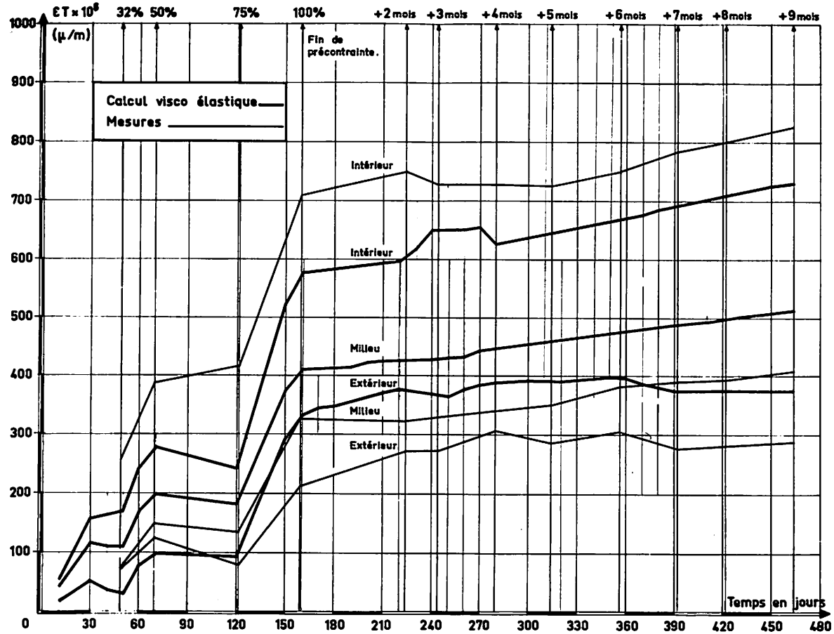
CAISSON DE BUGEY 1 : EVOLUTION DES DEFORMATIONS CIRCONFERENCELLES A MI-HAUTEUR DU CAISSON • FIG :
