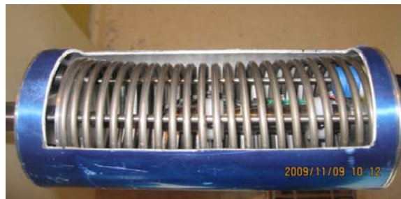
(d) A cut open test of extensometer
